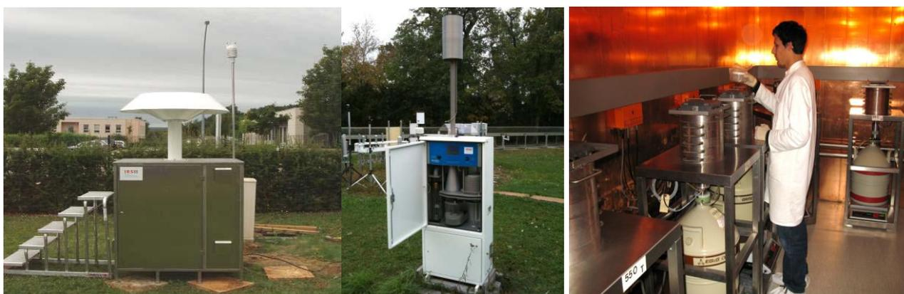
*Figure 1 - Équipements du réseau OPERA-Air de l'IRSN : station de collecte d'aérosols à très grand débit (TGD) à gauche, station de collecte des aérosols à débit intermédiaire (Vésinet) au milieu, et salle blindée des spectromètres gamma du laboratoire IRSN d'Orsay.*
